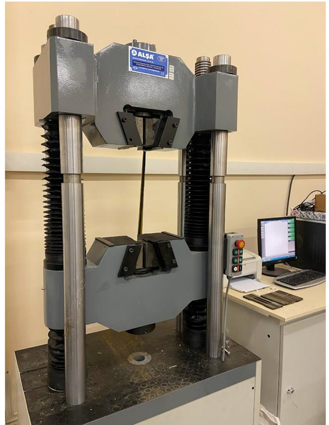
Fig. 5. Tensile testing device (ALŠA AB-0066-K)
